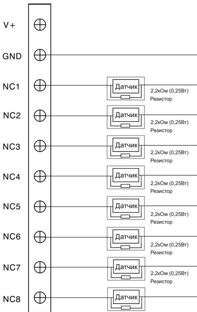
2. Подключение датчиков охранной сигнализации с нормально закрытыми типами контактов:
