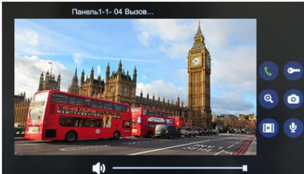
Нажмите кнопку для ответа на звонок, и кнопку для завершения вызова. Для открытия двери нажмите кнопку . При входящем вызове автоматически сохраняется 1 фотография в памяти внутреннего монитора. Во время разговора с посетителем, нажатие на кнопку разворачивает изображение на весь экран, а кнопка сохраняет текущее изображение в память внутреннего монитора. Для записи видео нажмите кнопку , или кнопку для записи только звука.
