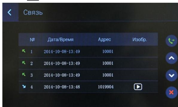
↖ - обозначает исходящий вызов; ↗ - обозначает входящий звонок; ↘ - обозначает не отвеченный входящий звонок; Всего хранится до 20 записей в списке.
