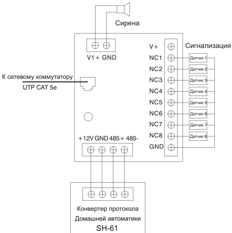
Подключение разъемов на задней стенке внутреннего монитора.
