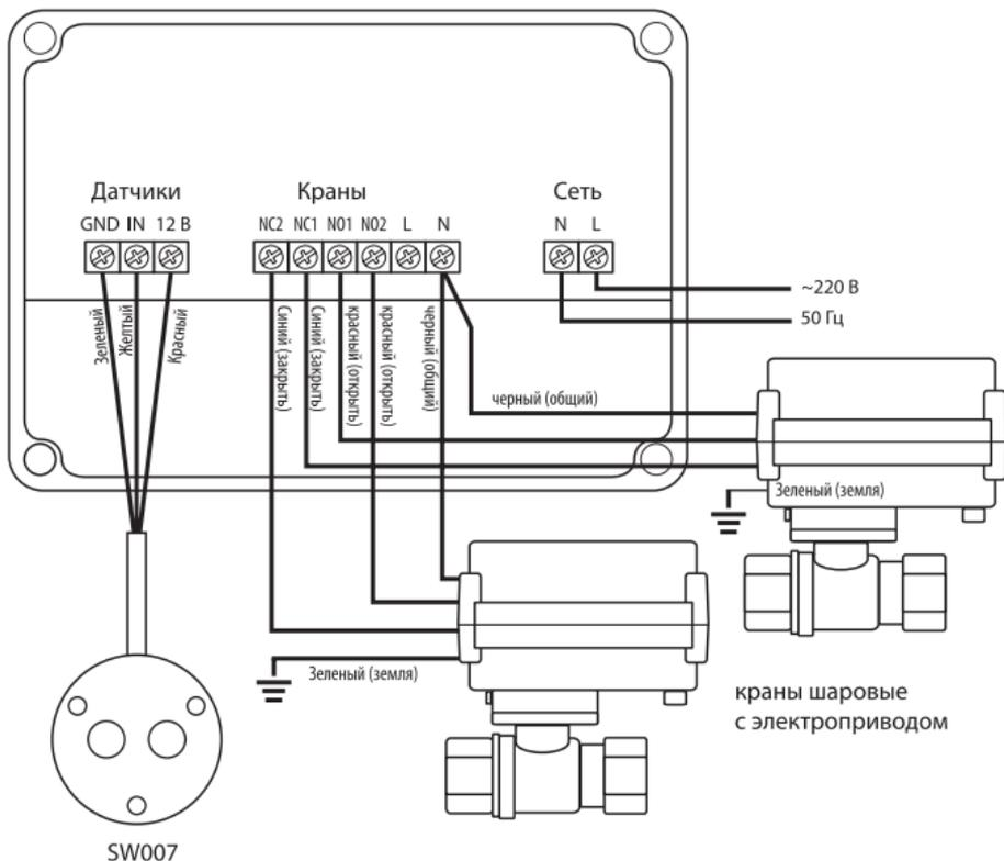
Рис. 7. Схема подключения датчиков, кранов с электроприводом серии Neptun Bugatti Pro 220 В к модулю управления Neptun Base
