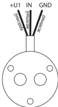
Рис. 5. Маркировка проводов.
